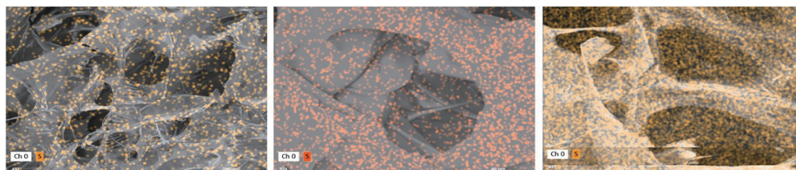
図 2 リパーゼを吸着したゲルの SEM-EDX 画像 (硫黄マッピング) (左：キサンタンガム 中：ローカストビーンガム 右：グアーガム)
